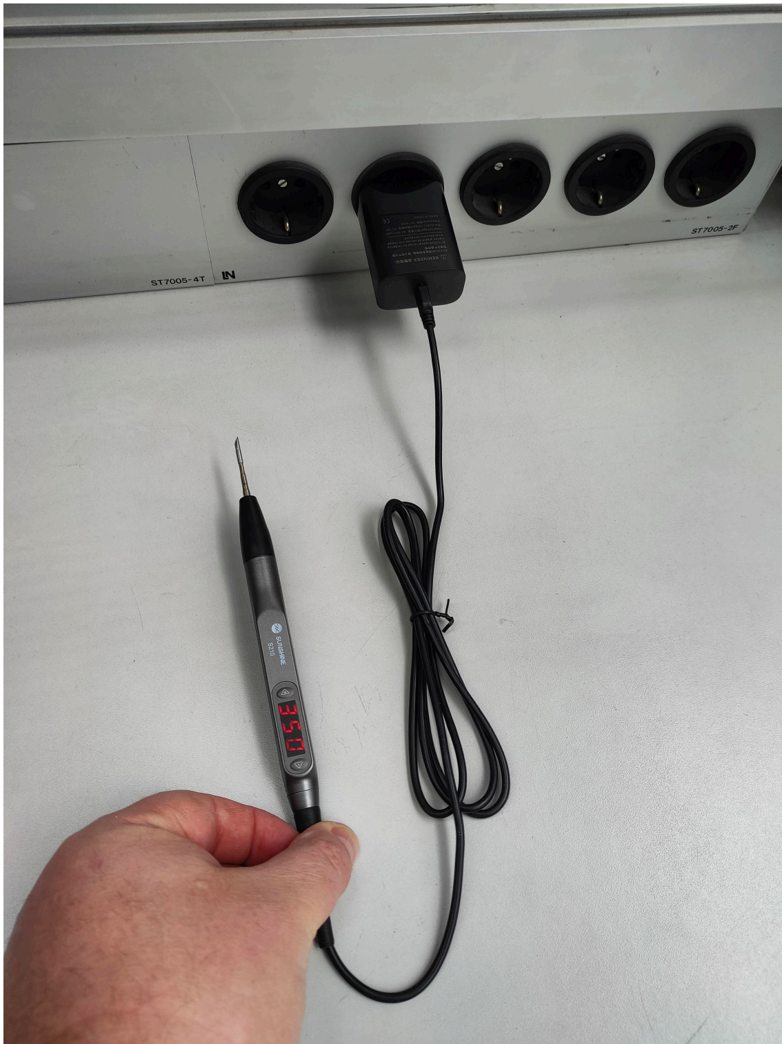
Ein Magnet führt zur Stand-By Abschaltung
